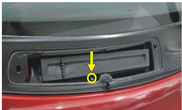
**(PL)** Odkręcić wkręt pokrywy filtra, usunąć pokrywę
